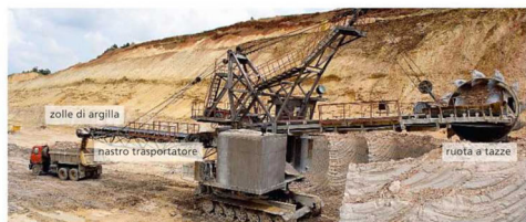
Uno scavatore con ruote a tazze in una cava di argilla.
